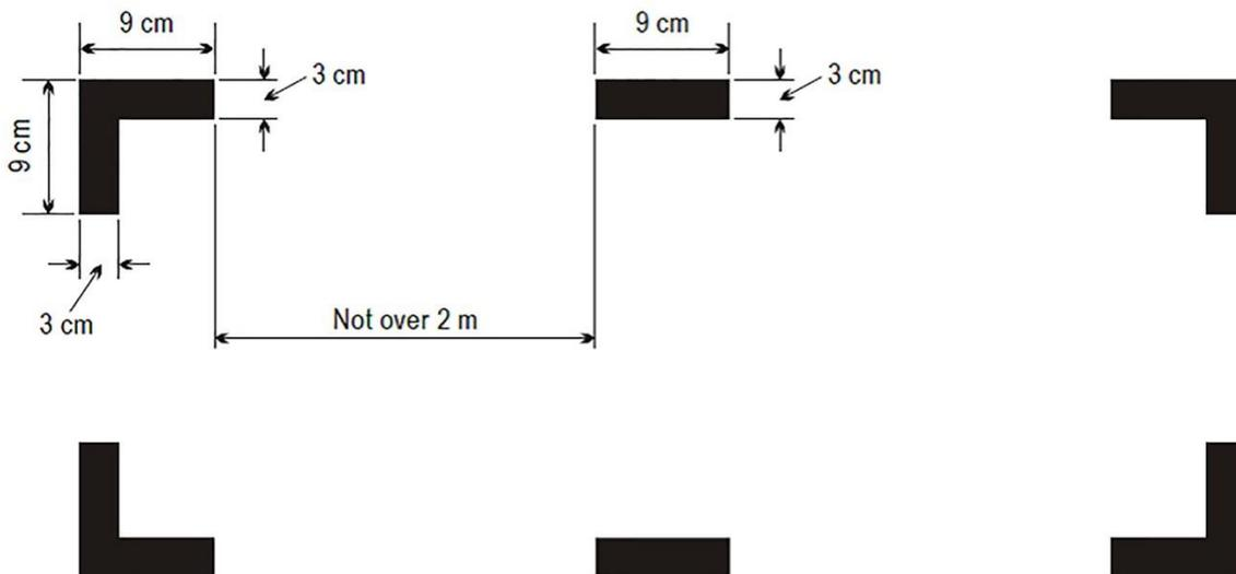
**AMC1 SPO.IDE.H.185 MARKING OF BREAK-IN POINTS****COLOUR AND CORNERS' MARKING**
