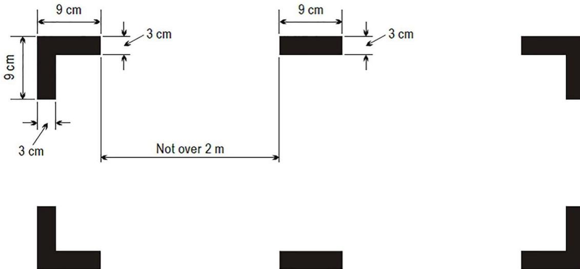
**AMC1 SPO.IDE.A.185 MARKING OF BREAK-IN POINTS****COLOUR AND CORNERS' MARKING**
